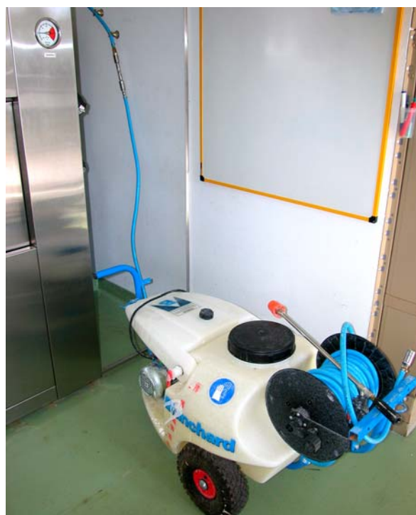
Photo 1 © T. Mauduit/Inra Ensemble du dispositif : Cuve de traitement, tuyau, raccords, tuyau en traversée de paroi
