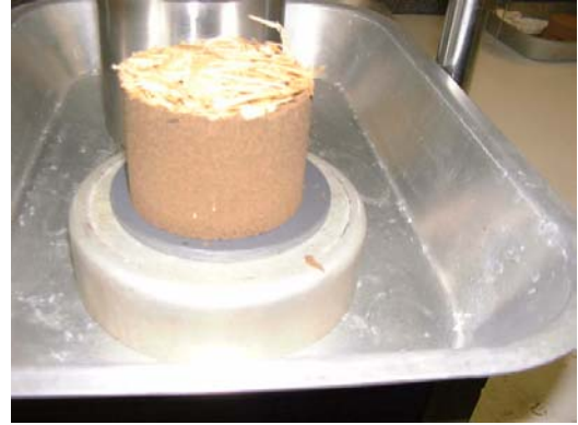
Fig. 2 : Exemple d'une éprouvette de sol obtenue avec le dispositif de la fig. 1 avec incorporation de résidus de paille en surface du sol.
