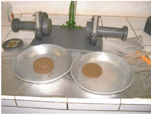
Fig. 3 : Récupération de l'éprouvette de sol et d'une tranche de sol.
