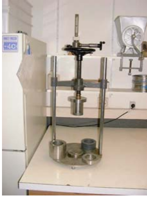
Fig. 1 : Dispositif utilisé pour préparer les éprouvettes de sol restructuré (Fazzolari et al., 1998a).
