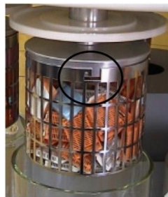
Figure 3. Installation du panier sur l'automate (petites encoches à enclencher pour bien maintenir le panier autour du cercle noir) (photo : INRA).
