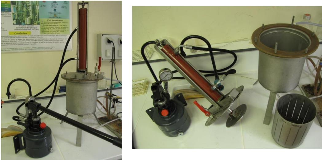
*Figure 2. Vues d'ensemble du presseur inerté : pompe hydraulique, cuve, cage et couvercle + vérin-piston (photo : Y. Sire).*
