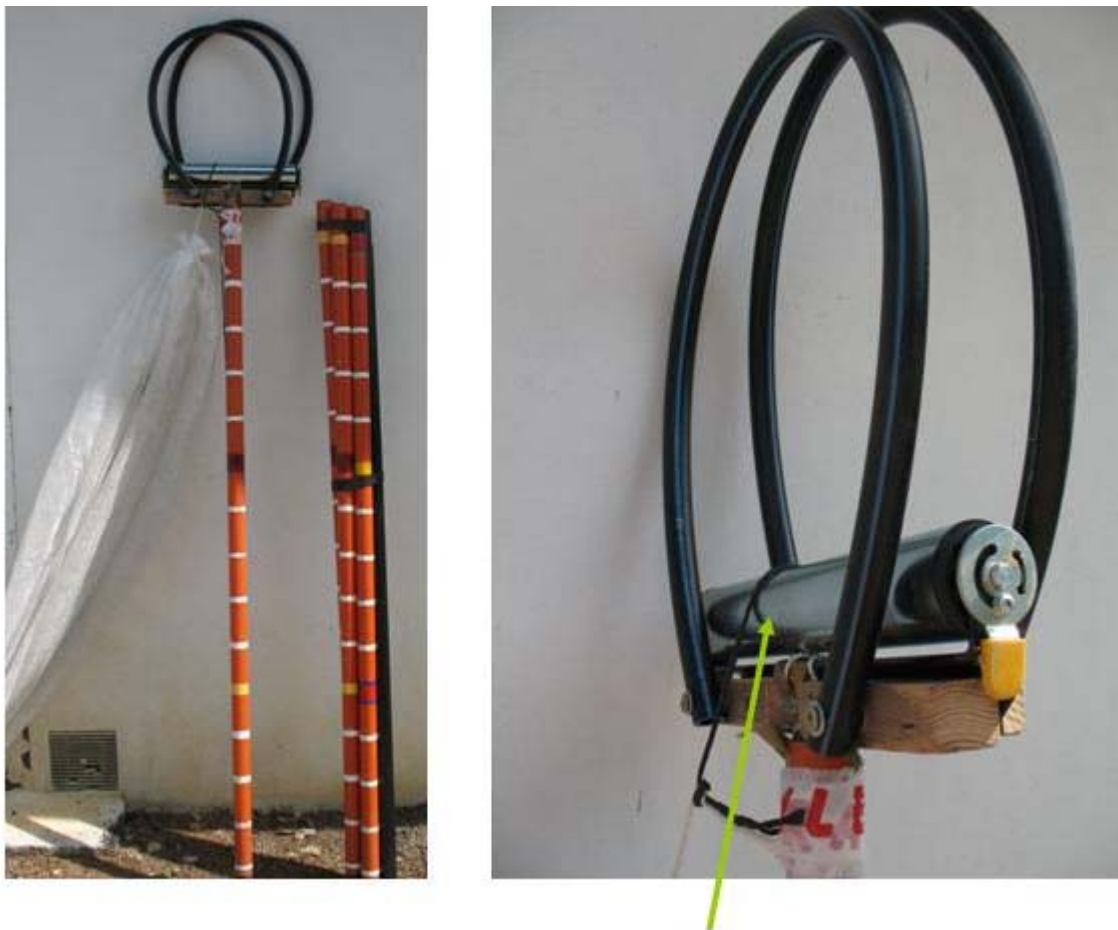
Photo 4 et 5 © Inra/G. Roussel : perche équipée d'une servante et de tuyaux rigides servant de guide lors du passage de la « chaussette »
