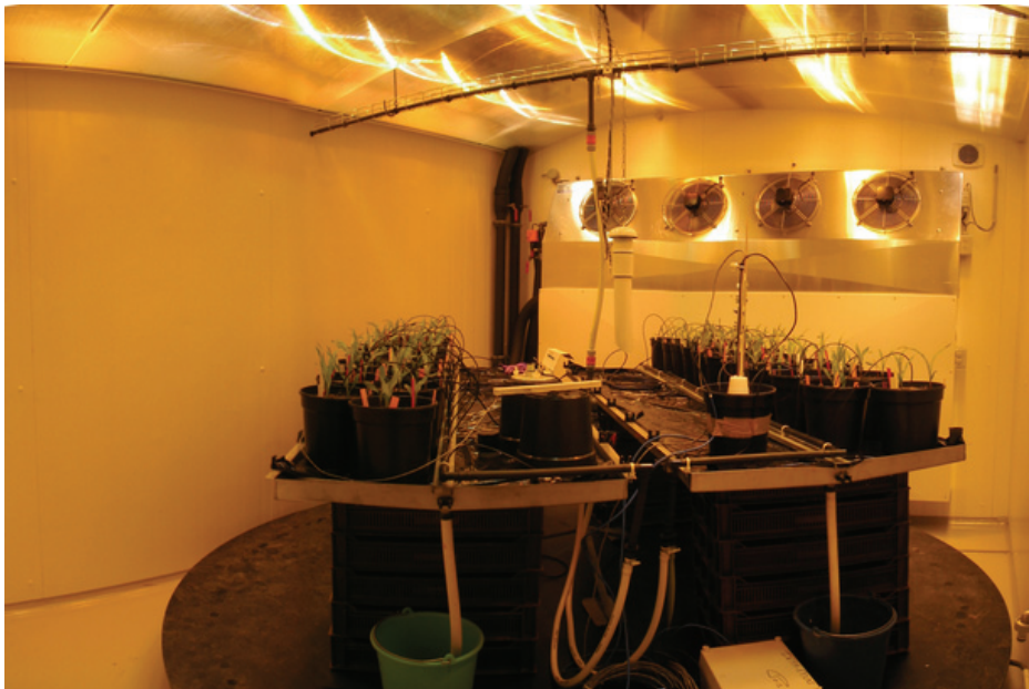
Figure 1.1 : chambre de culture A (24 lampes à décharge 400 W, plateau rotatif)
