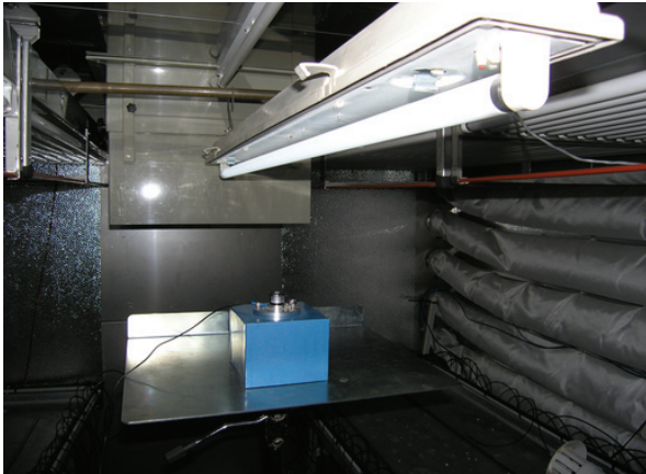
figure 24 : montage expérimental de mesure de l'éclairement d'une source étendue (tube fluorescent Osram Biolux 36W)
