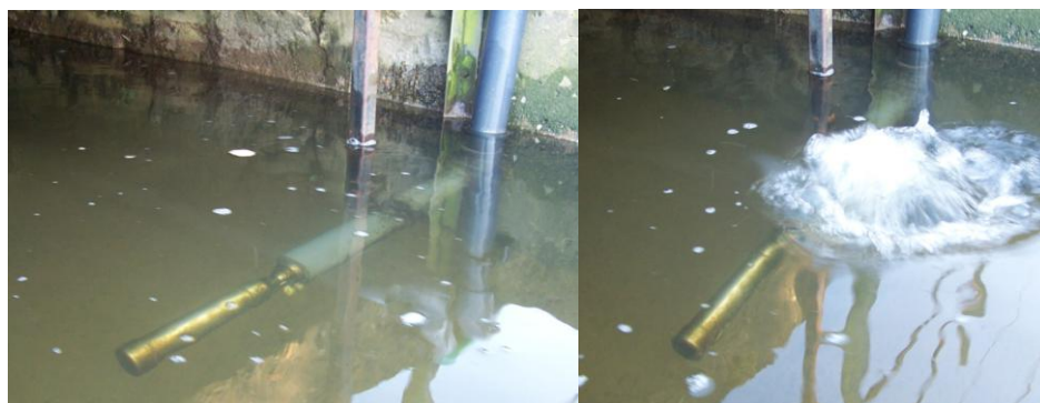
Figure 3. Spectrolyser en place à l'exutoire du bassin versant de Kervidy-Naizin et système de nettoyage par air comprimé (Photos M. Fauchoux)
