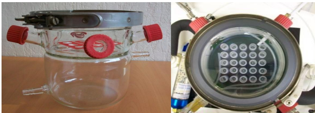
Figure 4. a) Photo de l'enceinte climatique (réacteur contenant l'air contrôlé), b) vu du dessus de l'enceinte montrant la disposition des tubes contenant les virus mis dans l'enceinte (photo : @EMMAH)
