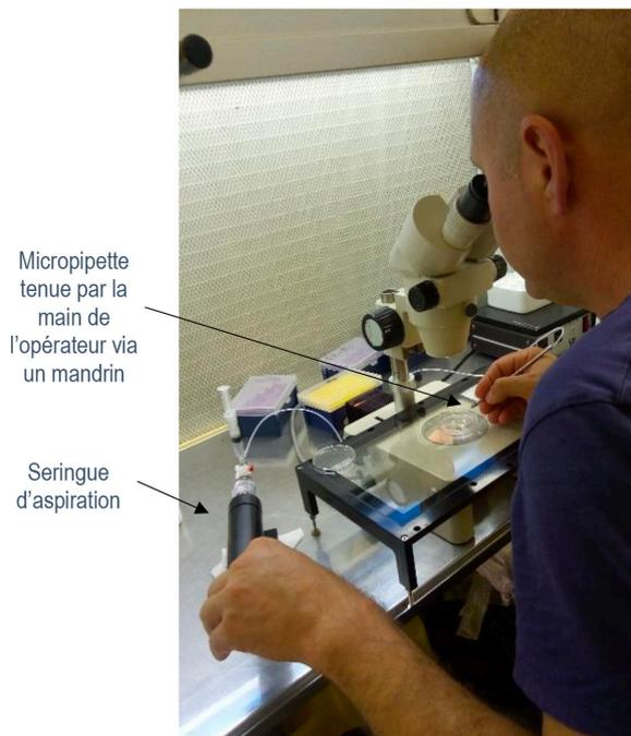
Figure 2. Placement des mains de l'opérateur lors de l'aspiration du liquide blastocœlique. La main droite de l'opérateur tient un mandrin au bout duquel est attachée une micropipette d'aspiration en verre. Sa main gauche est posée sur la vis de la seringue qui sert à aspirer le fluide embryonnaire.
