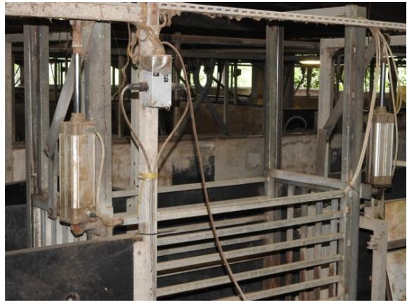
Photo 5. Cage de pesée fermée (portes abaissées)
