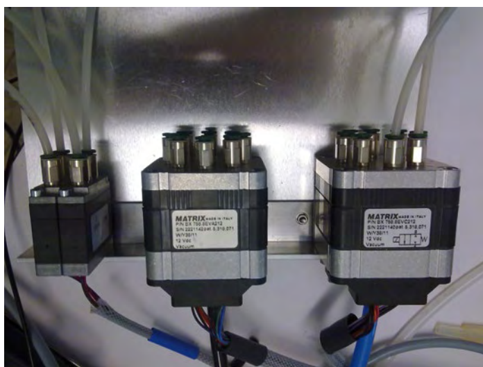
Figure 3. De gauche à droite BX721 (*2), BX 758 NO et BX758 NC. Tous les tuyaux ne sont pas raccordés (photo : P. Gross).
