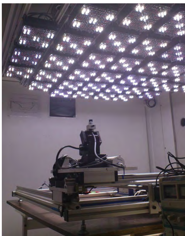
Figure 9. Cartographie de l'ECOLUX avec la combinaison cinq pavés de LED blanches et sept pavés de LED rouges sombres (photo : E. Roy, INRA).
