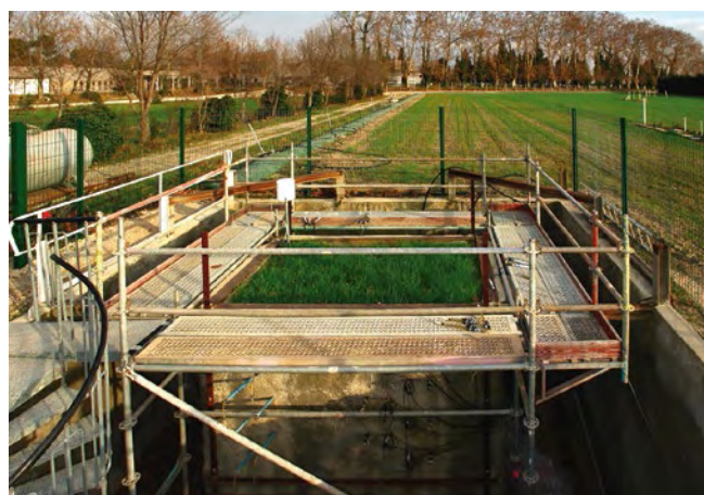
Figure 2. Photographie de la façade ouest du lysimètre (photo : EMMAH).
