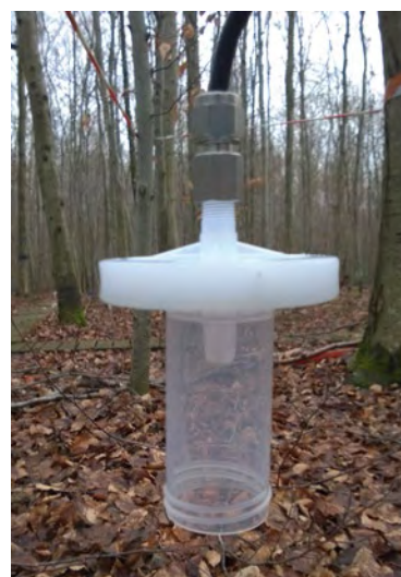
Figure 4. Filtre PALL ACRO 50 avec sa protection anti-pluie (photo : P. Gross).
