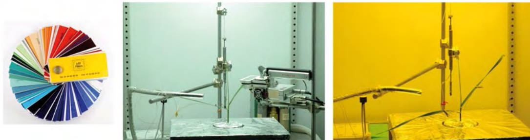
Figure 10. De gauche à droite : nuancier de filtres, enceinte de culture lampe HQI + HT 216, enceinte de culture lampe HQI + HT 015 (photo : S. Carre, INRA).
