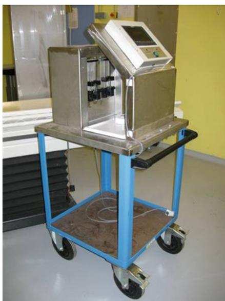
*Figure 10. Vue de l'injecteur automatique ; (photo : E. Bobillier).*
