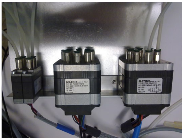
Figure 3. De gauche à droite BX721 (*2), BX 758 NO et BX758 NC. Tous les tuyaux ne sont pas raccordés (photo : P. Gross).
