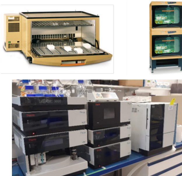
Figure 3. Photos des incubateurs Minitron et Microtron ainsi que de la chaîne de chromatographie liquide ultra-haute performance (UHPLC) couplée à un spectromètre de masse.
