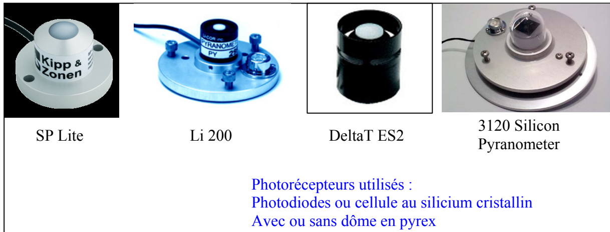
Figure 15 : Exemple de pyranomètres à photorécepteurs quantiques
