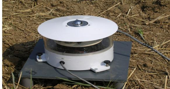
**Figure 2:** *Pyrgéomètre Eppley muni d'une ventilation*
