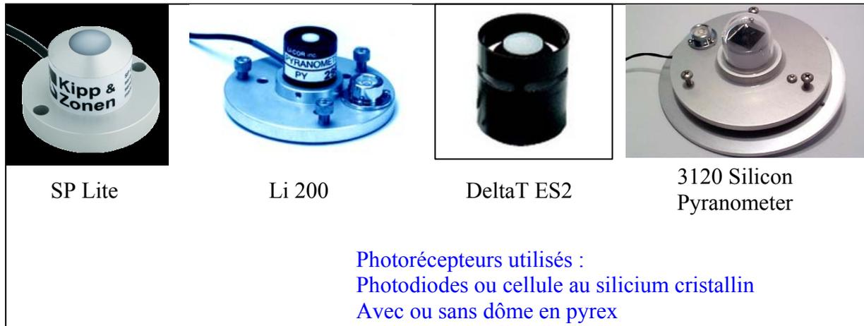
**Figure 15 :** Exemple de pyranomètres à photorécepteurs quantiques
