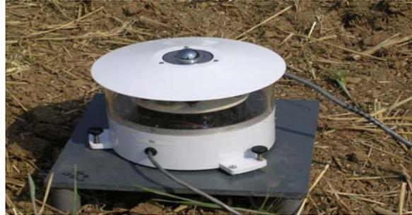
**Figure 2:** Pygéomètre Eppley muni d'une ventilation
