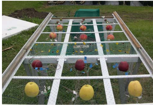
Figure 1 : Dispositif de mesure de la température de différents fruits
